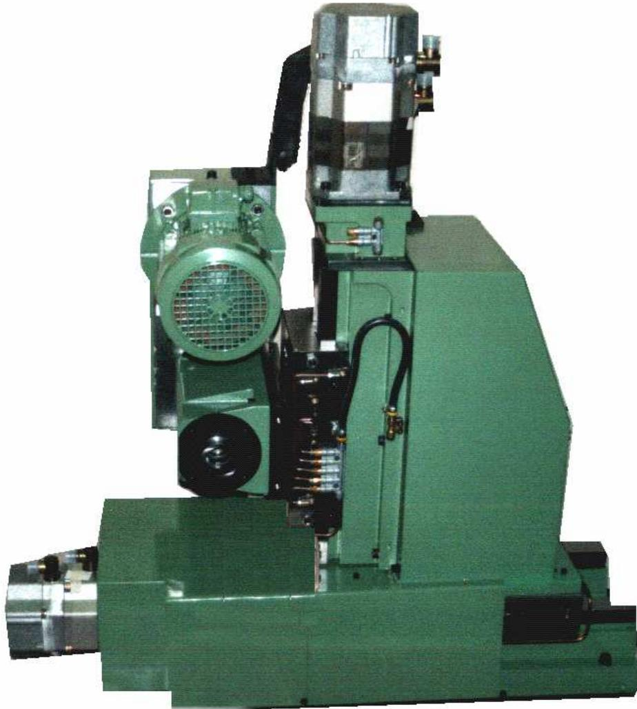
**Aufbau:** Spindeleinheit BF 4 mit Drehstrom – Normmotor und HSK – A 63
