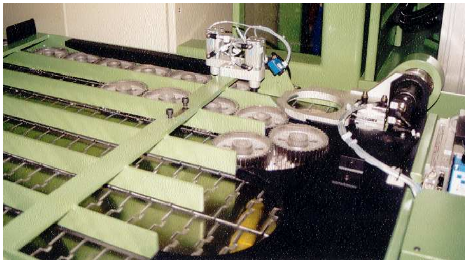
Die Werkstücke werden im Magazin vereinzelt, vorausgerichtet und durch eine Schwenkeinheit umgesetzt
