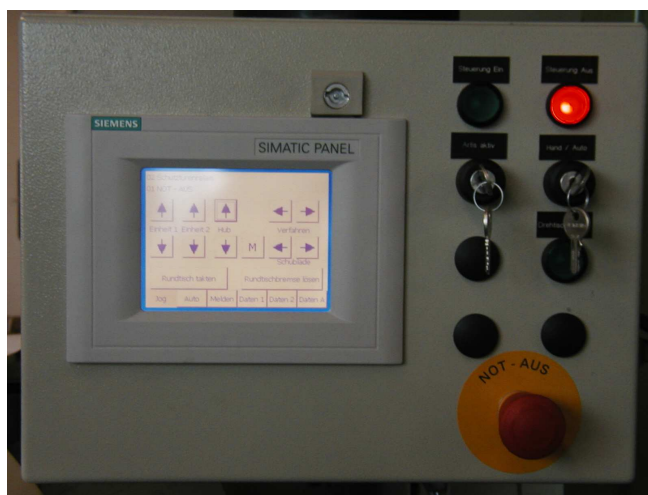
Maschinen-Bedienfeld mit Siemens Touch Screen Direkte Bedienung und Justierung der Maschinen- funktionen und -parameter über einfache Menue- führung möglich
