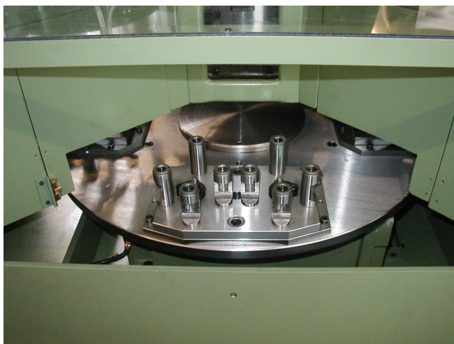
Beladestation durch Lichtgitter geschützt Vorrichtungen zum Auflegen der Werkstücke Die Werkstücke werden nicht gespannt oder fixiert
