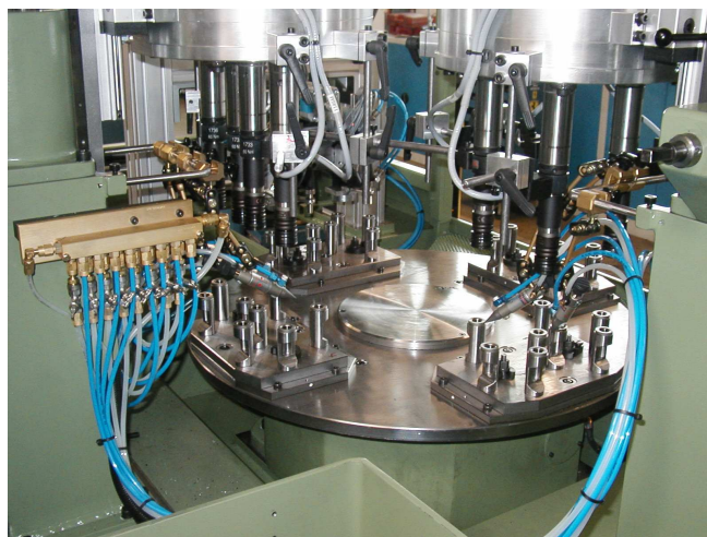
Ansicht des Maschinen-Innenraums durch geöffnete Werkzeug-Wechseltür „Pfeiffer“ Minimalmengen-Tropfendosierer zur Verhinderung von Luft-Emissionen
