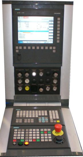
Bedientafel der CNC-Steuerung
