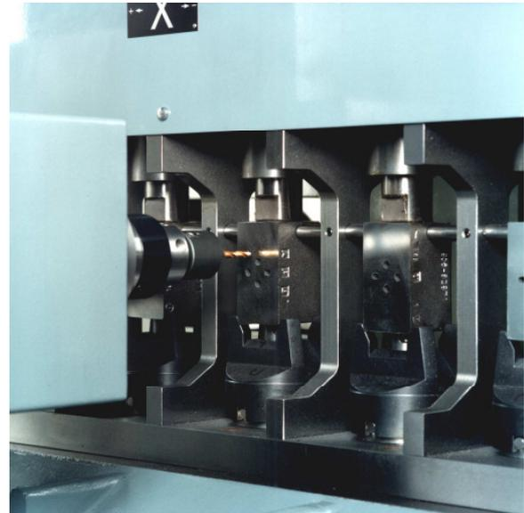
Zur Herstellung von Ausfräsungen in Automobilkolben.
