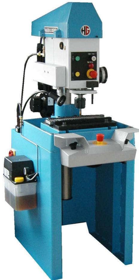
**Gewindemaschine HG-8E in Kastenständerausführung mit Fremdlüfter für höchste Takthäufigkeit, Zentralschmierung der Leitpatronensteuerung und Halogenleuchte**
